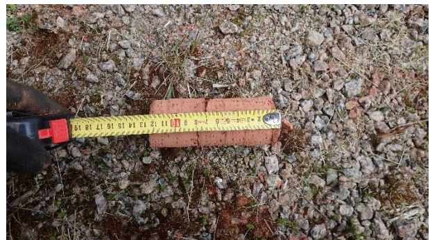
Kuva 21. RA1. Ulkoverhoustiilen/ulkokuoren paksuus noin 130 mm.
