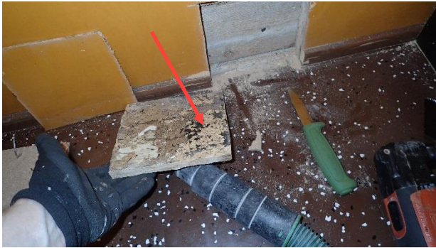
Kuva 119. Lastulevyn pinnalla oleva mustaliima sisältää asbestia.
