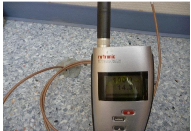
Kuva 11. RA3. Rakenneavaus tehtiin porauksella. Ilmatilan suhteellisen kosteus mitattiin täyttöhiekan päältä.
