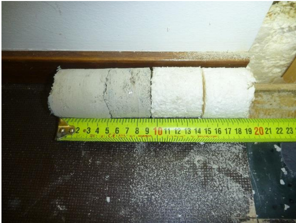
Kuva 40. Kuva lattiarakenteesta poratusta näytteestä.
