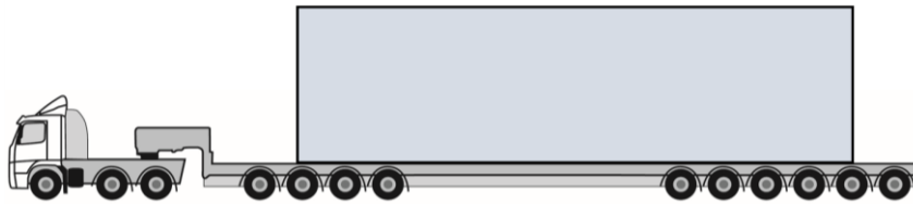
Kuva 4: Tyypillisen tornilohkokuljetuksen havainnekuva (ei mittakaavassa).
