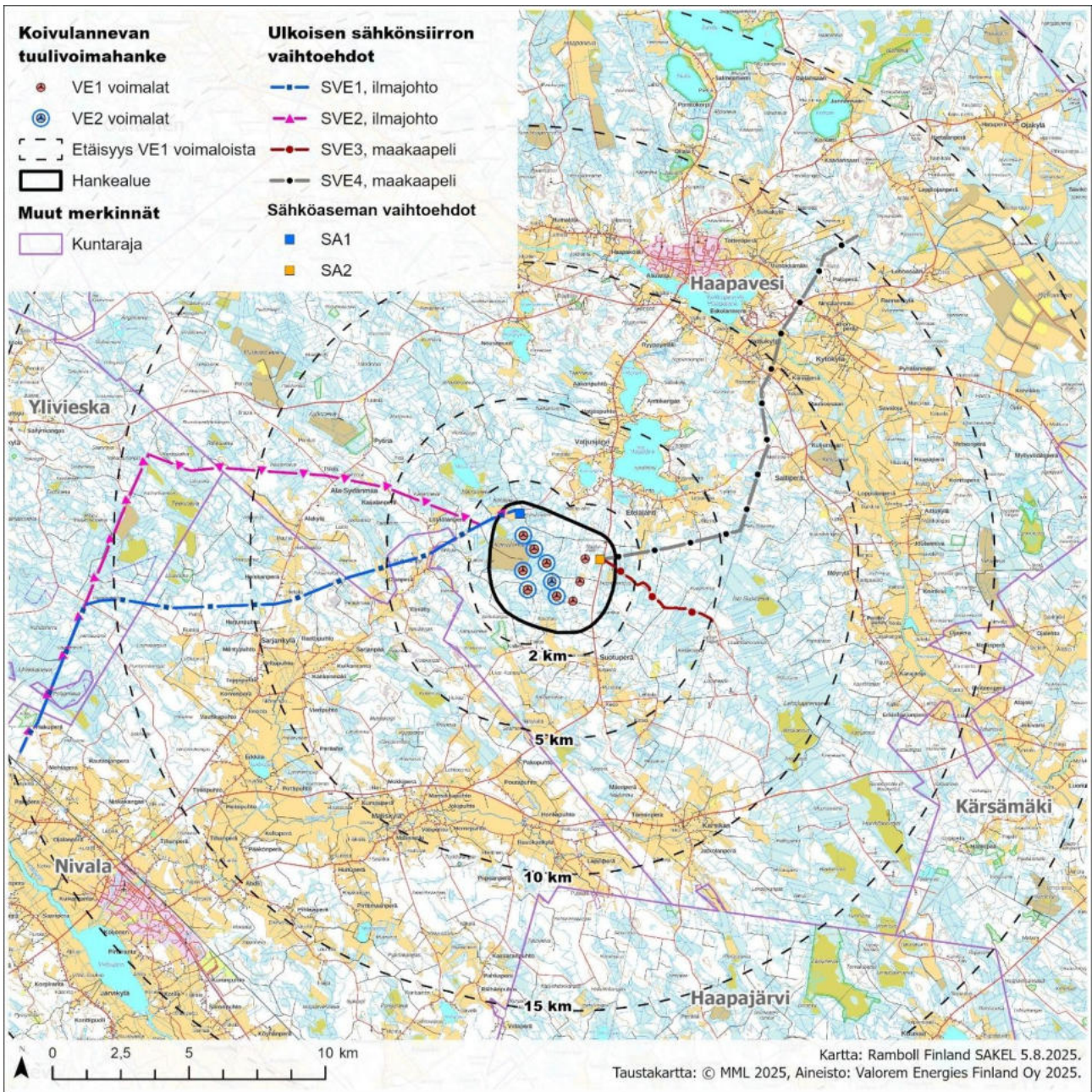
Kuva 1-1. Koivulannevan tuulivoimapuiston sijainti, YVA-selostuksessa käsiteltävät hankevaihtoehdot VE1 ja VE2 sekä sähkönsiirron vaihtoehdot SVE1, SVE2, SVE3 ja SVE4.
